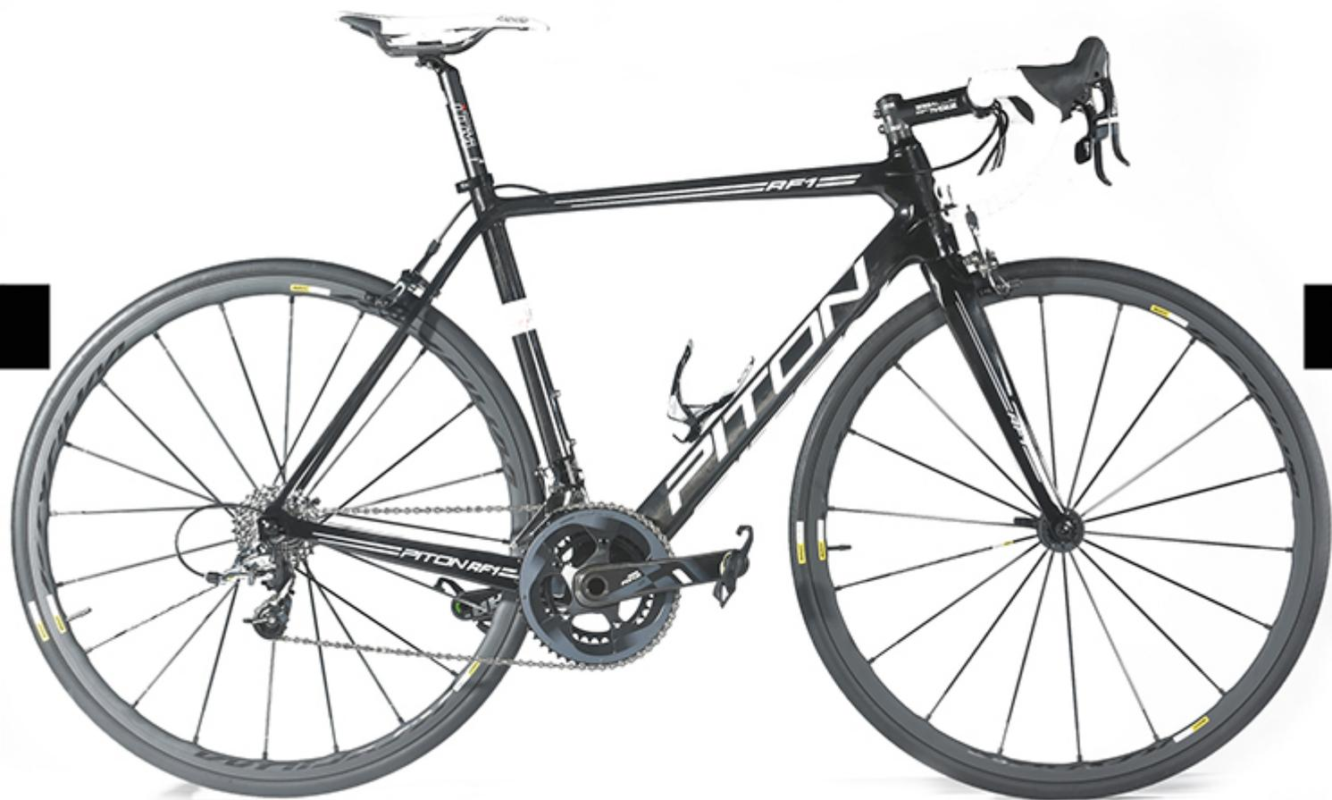
Il telaio RF2 DISC è un telaio monoscocca in fibra di carbonio 30T.
